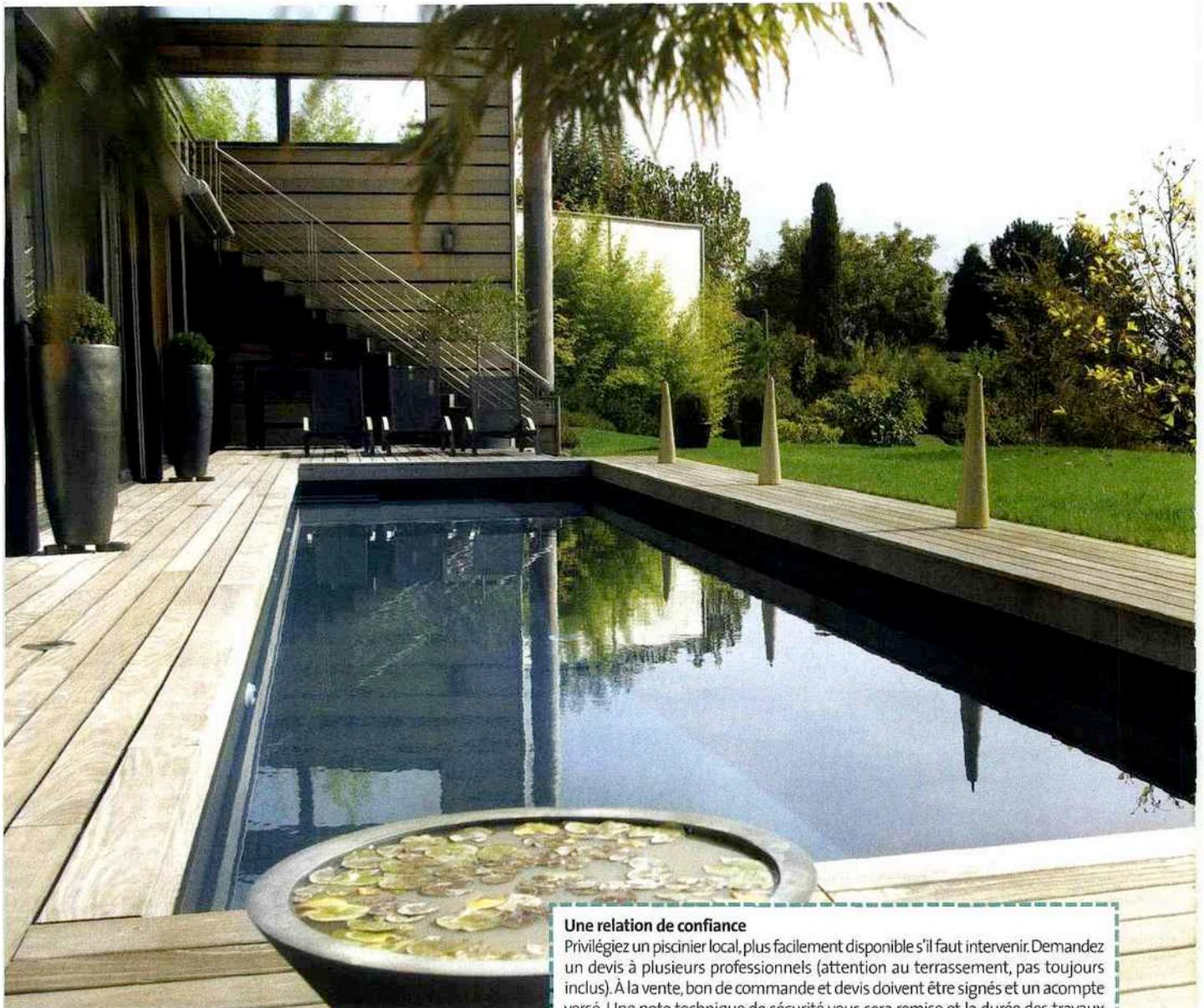
Liner noir, plages et margelles en ipé pour ce couloir de nage maçonné de 16 x 3 m. Carré bleu.
