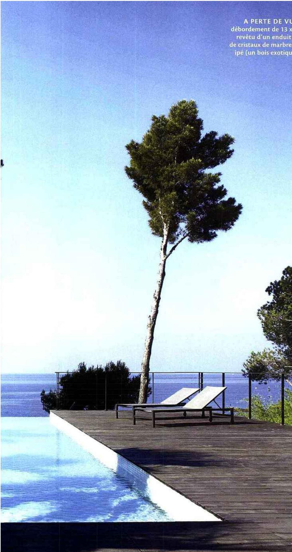
**A PERTE DE VUE** Ce magnifique bassin à débordement de 13 x 4 m, en béton projeté, est revêtu d'un enduit à base de ciment blanc et de cristaux de marbre, et entouré d'une plage en ipé (un bois exotique). Diffazur, prix sur devis.
