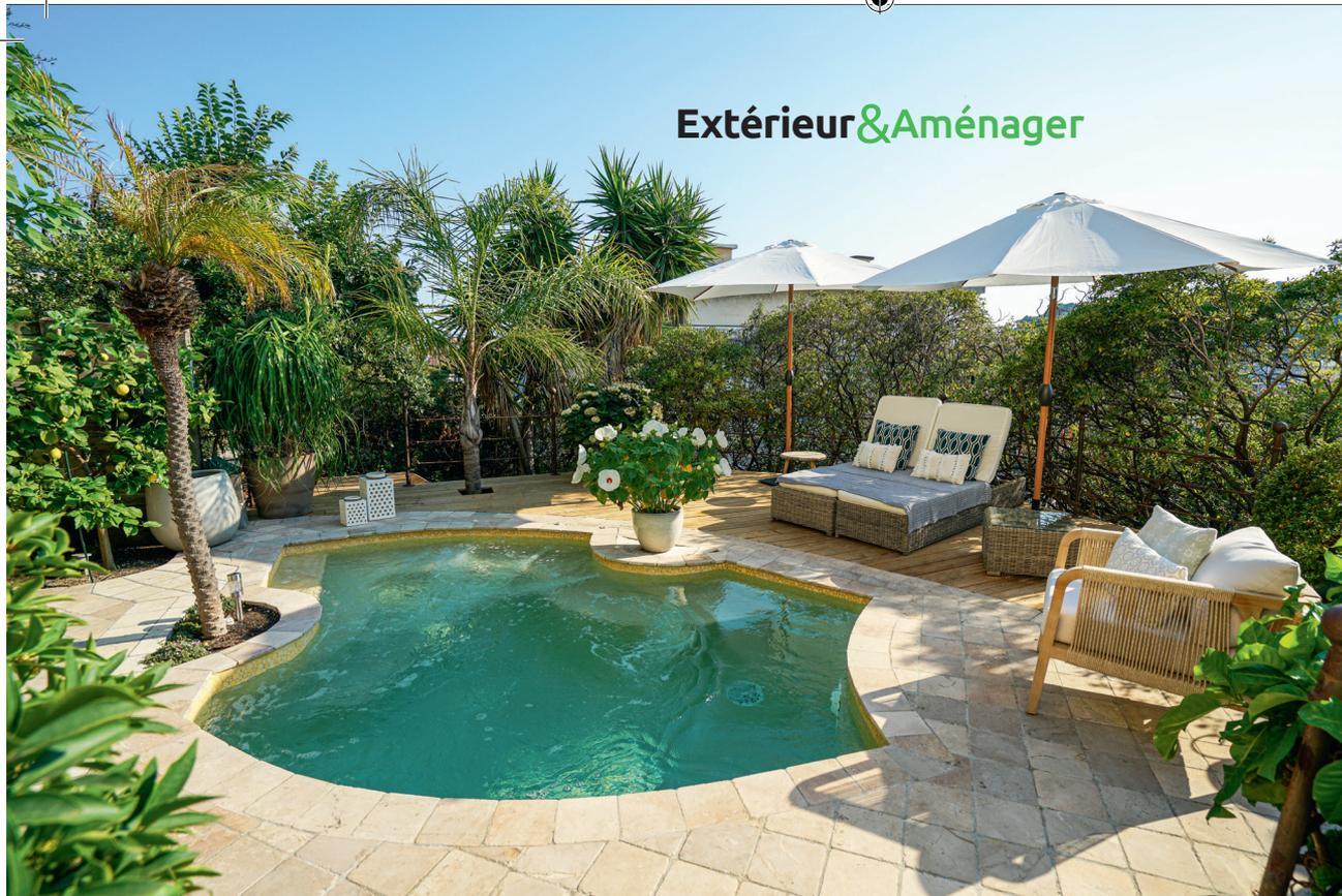
**Ci-contre.** Mini-bassin sur mesure en béton armé Gunite, revêtement minéral à base de cristaux de quartz, effet pailleté. Nettoyage automatique par bondes de refoulement, filtre à sable, électrolyse au sel, régulation automatique. Chauffage, éclairage. Balnéo, nage à contre-courant. Plage en marbre vieilli et bois, escalier intégré. « Ixess », L4,50 x L2,10 x P0,90 à 2,10 m, prix sur devis. **DIFFAZUR**
