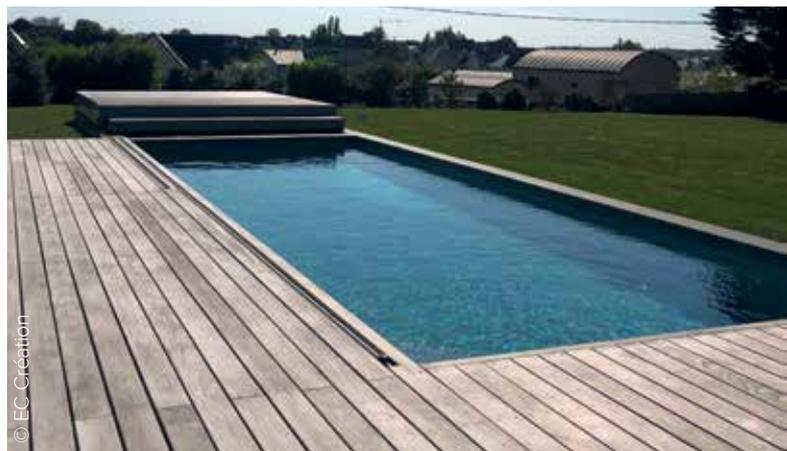
Les habillages en bois sont plébiscités par les clients. Ici, une réalisation d'EC Création où deux modules s'imbriquent l'un dans l'autre pour limiter le recul nécessaire à l'ouverture de la terrasse mobile.
