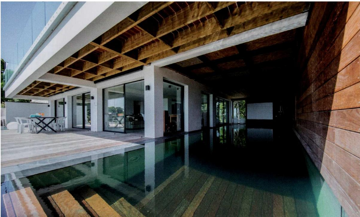
**Dedans dehors.** Trophée d'Or 2019 de la FFP, catégorie piscine d'exception, ce bassin miroir de 11x3,5m installé entre intérieur et extérieur est équipé d'un fond mobile qui se relève et recouvre l'eau. Réalisation Piscine JMS, **L'Esprit Piscine.**
