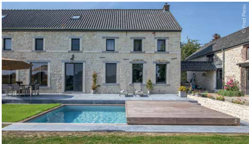
La terrasse mobile, composée de deux parties, coulisse sur des rails en aluminium anodisé leur conférant une grande résistance à la corrosion. La fermeture et ouverture du bassin est aisée. Un dispositif à la fois sécuritaire, pratique et esthétique.
