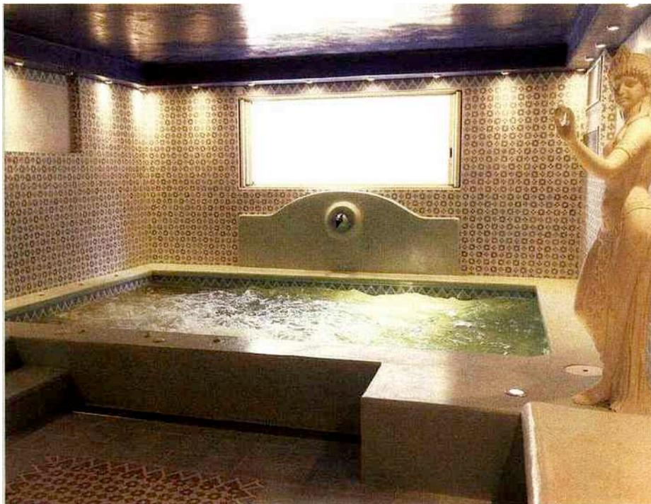
**SPA DIFFAZUR** Spa de nage dimensions 4 70 x 2 75 m profondeur mini et maxi 0 90/110 m superficie 12 37 m² Filtration de type Diffaclear avec débit 14/16m³/h pompe 1 puissance 15 CV Equipements diffaclear diffapur nage à contre courant diffaswim espace balneo integre avec 3 jets venturi et booster 15 cv regulation de niveau d'eau une prise cascade Margelles en pierre reconstituée revêtement crystalroc hpm sable marbre
