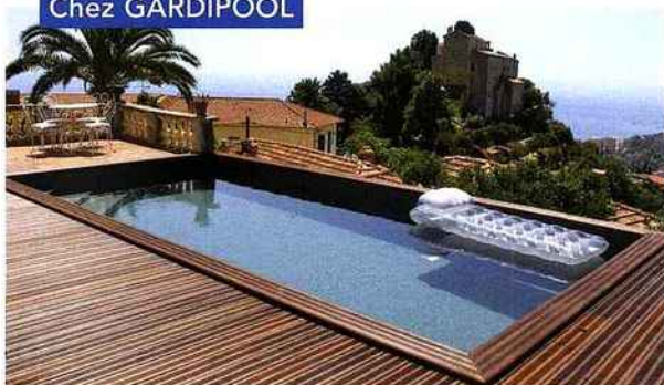
Piscine en pin rouge du Nord traité autoclave classe IV. Structure auto-portante avec profilés en métal galvanisé.
