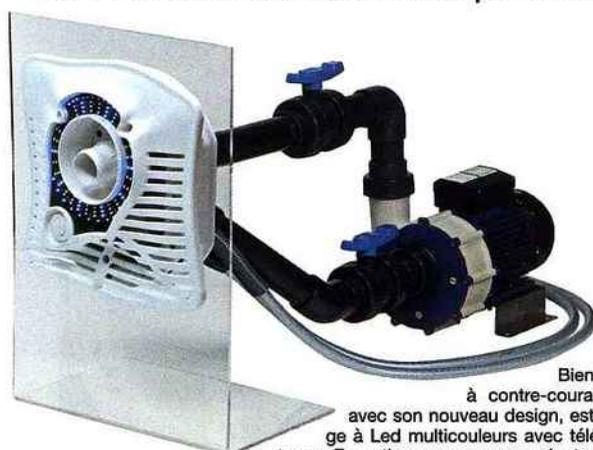
Ce bloc technique hors-bord complet assurant la filtration est pré-équipé pour recevoir un système de nage à contre-courant. Lorsque celle-ci est intégrée, elle bénéficie d'une pompe indépendante. En option, une lance de massage et des projecteurs sont proposés.
