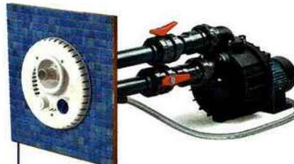
Ce kit complet de nage à contre-courant est adaptable à toutes les piscines quel que soit leur revêtement (béton, liner, polyester, bois). Il est composé d'une pompe, d'une façade, de pièces à sceller, d'un coffret pneumatique avec protection thermique, d'un capillaire et d'un tube air. Il est possible de régler le débit d'air et d'eau et l'orientation de la buse. NCR d'Espa.
