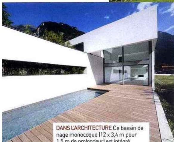
**DANS L'ARCHITECTURE** Ce bassin de nage monocoque (12 x 3,4 m pour 1,5 m de profondeur) est intégré à la maison. Il est constitué d'une structure isolante en nid-d'abeilles. Les marches d'accès disposées sur le côté, dans l'eau, sont suffisamment larges pour servir de plage de repos (modèle « Z.k 12-03 », LPW).
