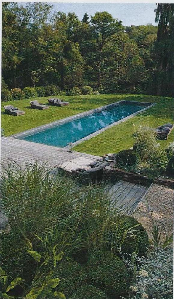
**PIÈCE D'EAU.** Couloir de nage chauffé (pompe à chaleur), escalier maçonné et volet immergé, revêtement membrane armée gris foncé, filtration à sable, projecteurs, L 21 x l 4 x prof. 1,4 à 1,60 m, prix sur mesure, Carré Bleu.
